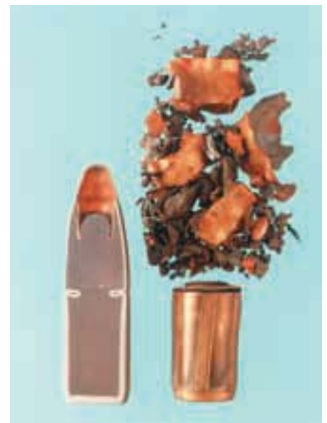
Teilerlegergeschoss .308" H-Mantel Kupferhohlspitze 9,3 mm 16,7 g/257 gr. Der Vorderteil hat sich programmgemäß in Splitter zerlegt. Der hintere – leicht gestauchte – Kern bleibt intakt und bewirkt Durchschlagskraft. Alle Fotos: P. Grieder
