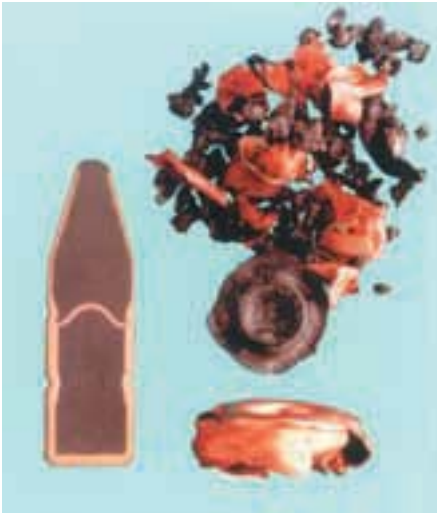
Bei entsprechend großem Zielwiderstand und großer Auftreffgeschwindigkeit zerlegen sich auch Teilzerleger ganz. Hier das 10,7 g/165 gr .308" DK Geschoss mit zerlegtem rückwärtigen Kern.
