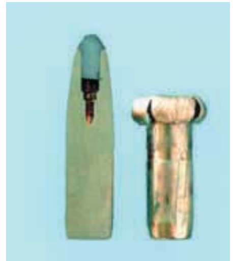
Deformationsgeschoss. Das neue, bleifreie 308-Geschoss Lapua Naturalis 11 g/170 gr steht hier als Beispiel für ein prächtig aufpilzendes Deformationsgeschoss. Es wurde mit 639 m/s durch 4 cm Gelatine geschossen.
