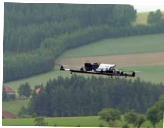
Der Oktokopter – ein mit Infrarot und Digitalkamera bestücktes Fluggerät zur Kitzrettung. Quelle: ORF OÖ
