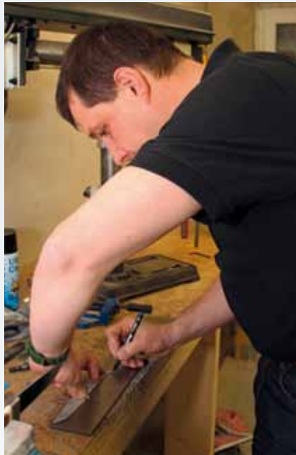
Zunächst wird die gewünschte Form des Messers mit Hilfe einer Schablone auf den Rohling gezeichnet.
