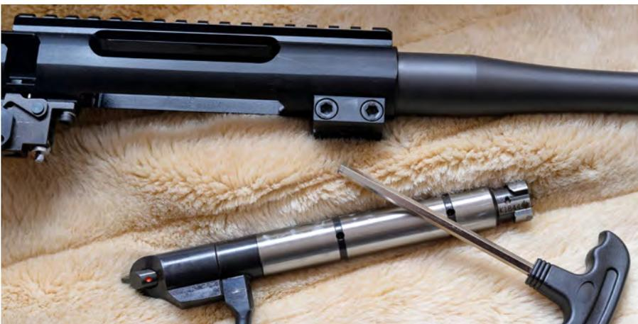
▲ Abb. 3: Für den Laufwechsel werden die beiden Systemschrauben unten gelöst, das System aus dem Schaft genommen. Über zwei Klemmschrauben am vorderen Ende des Systems kann der Lauf entnommen und gegen einen anderen getauscht werden. Bleibt man in der gleichen Stoßbodengruppe, ist nur der Laufwechsel notwendig (in einigen Fällen muss auch das Magazin getauscht werden). Springt man in eine größere oder kleinere Gruppe, muss auch der Verschluss getauscht werden.
