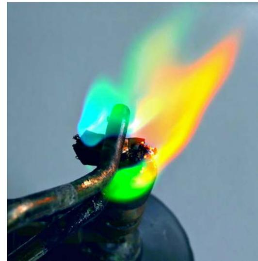
▲ Abb. 2: Beilsteinprobe zur qualitativen Bestimmung von Kunststoffen.
