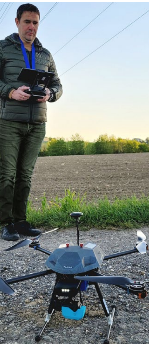
▲ Technik rettet Leben: Drohne mit Wärmebildkamera für die Kitzrettung.
